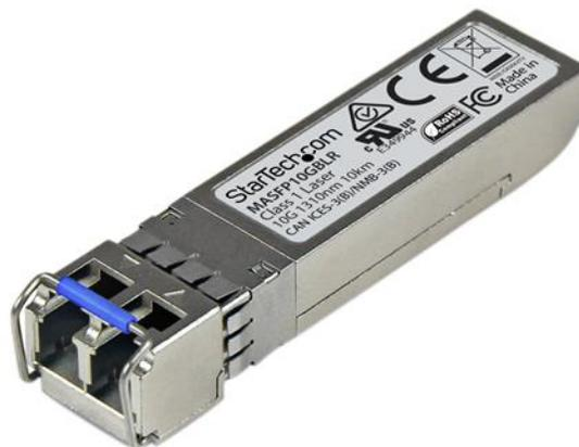
El modelo MASFP10GBLR es un módulo transceptor por fibra óptica compatible con el modelo MA-SFP-10GB-LR de Cisco Meraki, diseñado, programado y probado para su funcionamiento con enrutadores y conmutadores de la marca Cisco Meraki™. Ofrece conectividad 10GbE confiable a través de cable de fibra óptica para redes compatibles con 10GBASE-LR, con una distancia máxima de hasta 10km.
